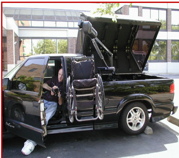
Ejemplo de elevador de silla de ruedas para camioneta (Foto cortesía de Shepherd Center)
